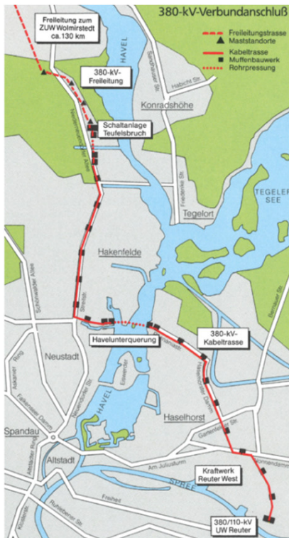
Bild 27: Trasse Teufelsbruch – Reuter (links) mit Havel-tunnel (oben)
